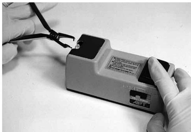
Temperatura: Não é necessário medir a temperatura para assegurar que está na escala correta, mas é recomendado para minimizar o excesso e o desperdício de material. Para o profissional que está começando a utilizar os Termo-alicates, medir a temperatura do Termo-alicate é imprescindível. Se a temperatura do Termo-alicate estiver abaixo da escala de termoplasticificação o termoplástico irá apenas esticar e conseqüentemente, quando posicionado na
